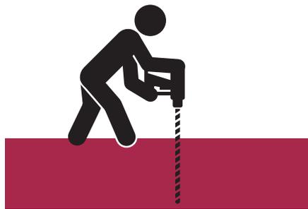
L'avant-trou mécanique peut être réalisé à l'aide d'un **perforateur burineur**. Adaptez le diamètre du foret au type de sol.
